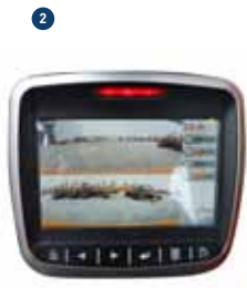
通过计算机将5个摄像头拍摄的视频 组合起来并实时显示， 让驾驶员360度无死角的技术。
