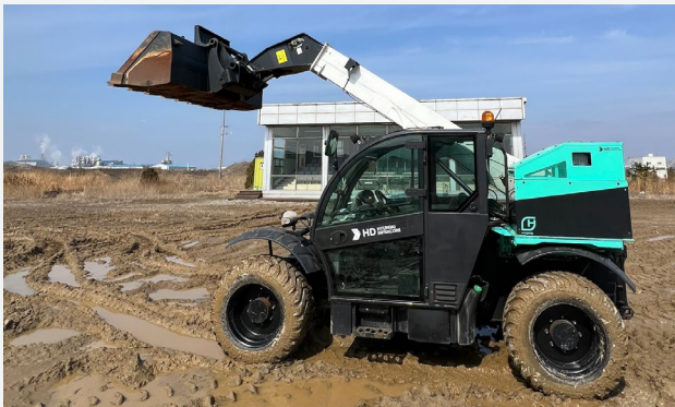
Full Hybrid Powertrain이 적용된 Telehandler 데모 장비
